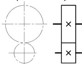
Цилиндрическая фрикционная передача
